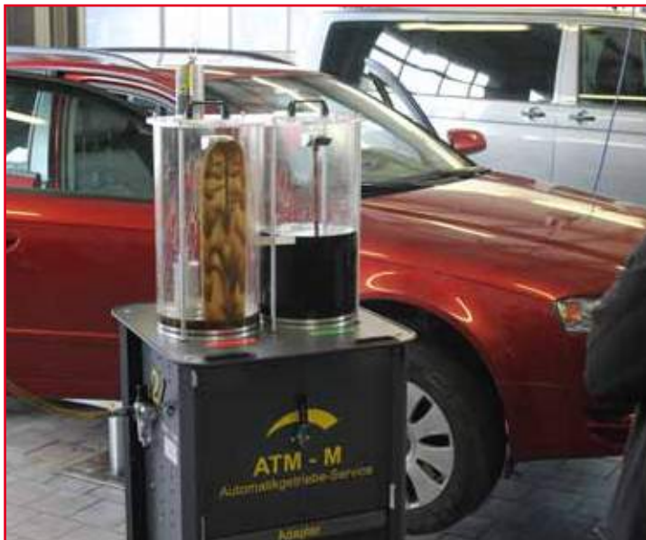
linker Zylinder: verschmutztes Öl rechter Zylinder: Frischöl
