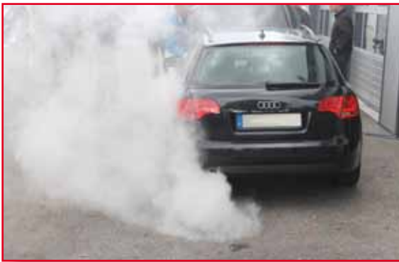
Ausstoß der Asche- und Rußpartikel mit den Abgasen
