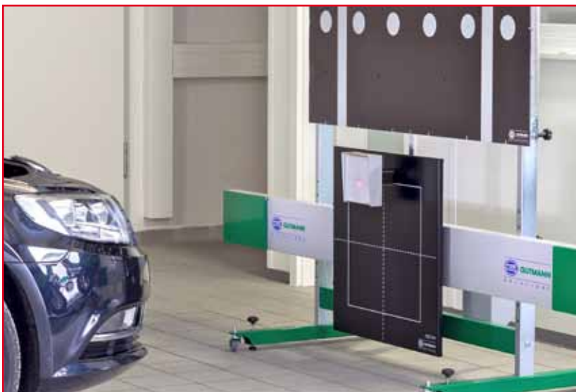
Hella Gutmann CSC-Tool mit Winkelverstellplatte für Radar-Systeme
